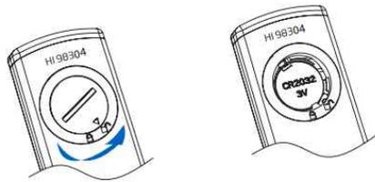
기기의 뒷면의 커버를 열어, 배터리를 교체 한다. 배터리가 없을 시, 기기 화면에 "dEAd bAtt" 표시가 화면에 나타난다.
