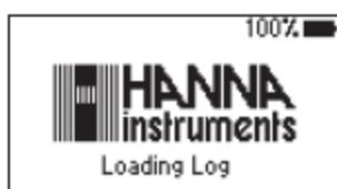
자동 꺼짐 기능은 설정된 기간(기본값 30분)동안 사용이 없으면 배터리 수명을 절약하기 위해 기계가 꺼진다. 기간을 설정하려면 SETUP참고. 자동 로징이 시작되면 기계는 입력을 관리하고 기록을 메모리한다. 자동로징을 멈추려면 StopLog를 누르거나 간단하게 기계의 전원을 끈다.
