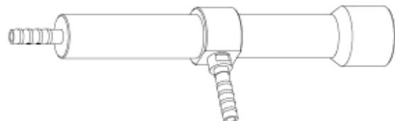
\* HI 98197 기기는 낮은 전도도 수치를 가지는 용액을 측정하기 위한, HI 763123 4 링 전도도/TDS프로브가 제공된다. HI 763123 은 초순수 물( $18.2\text{M}\Omega\cdot\text{cm}@25^\circ\text{C}$ ) 측정이 가능하다. 전도도 추시는  $0.001\mu\text{s}/\text{cm}$  단위, 저항 수치는  $0.1\text{M}\Omega\cdot\text{cm}$  단위로 측정된다. 초 순수물의 전도도/저항 측정은 탄산 (Carbonic Acid) 으로부터의 수분 ( $\text{H}_2\text{O}$ )과 공기 중  $\text{CO}_2$  이산화 탄소가 반응하기 때문에, 오픈형 용기를 사용하여 측정이 어렵다.
