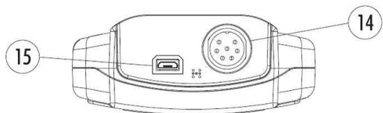
이 제품은 1.5V AA(4개)의 배터리가 제공됩니다. 미터기 안에 배터리를 넣어주세요. 컴퓨터와 연결하지 않을 때, 방수를 위해서 반드시 마이크로 USB 커버를 사용하세요. 이 제품은 DIN 커넥터를 이용해 전극과 연결됩니다. ON/OFF키를 사용해서 제품을 켜주세요. 제품을 켜면 처음에 한나 기계의 로고와 배터리 잔량 표시 뒤 측정 모드에 들어갑니다. 측정 이후 제품을 끄고, 전극을 청소한 뒤 몇 방울의 보존 용액(HI 70300)과 함께 보호캡을 씌운 뒤 보관합니다. 자동 전원 꺼짐 기능은 기기를 사용하지 않고 기기의 설정 시간(최초설정 30분)이 지나면 배터리를 절약하기 위해 자동으로 종료합니다. 자동 화면 꺼짐 기능은 일정 시간(최초설정 1분) 기기를 사용하지 않으면 자동으로 화면이 꺼지는 기능입니다.
