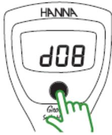
측정 모드에서 On/Off 버튼을 꾹 누른다. 계속 누르고 있으면 기기는 "OFF", "CAL" 메시지를 나타낸 후 현재 자동 꺼짐 설정으로 들어갈 것이다. 초기 설정은 8분("d08")이다. On/Off 버튼을 눌러서 원하는 시간으로 변경할 수 있다.
