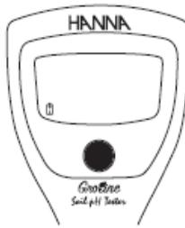
기기는 배터리 잔량이 낮은 상태에서 지시자를 제공한다. 배터리가 낮을 때, 화면에 깜박이는 표시가 나타날 것이다. 배터리를 더 이상 사용할 수 없는 경우, "Erb" 메시지가 화면에 나타난 후 기기 전원은 꺼질 것이다.
