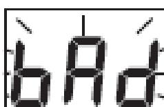
**Dead battery:** 이것은 배터리가 모두 소모되었고 교체되어야 함을 나타냄. 이 표시가 화면에 나타나면 정상적인 작동이 되지 않는다.
