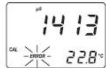
**Note** : 2 포인트 칼리브레이션이 항상 추천된다. 하지만 EC 칼리브레이션은 1 포인트에서도 측정이 가능하다. 오프셋 칼리브레이션을 위해서, 제로값의 칼리브레이션 이후에 CAL 버튼을 누른다. 기기는 정상모드로 돌아오게된다. 다음 칼리브레이션 표준용액을 생략하기 위한 칼리브레이션 절차이후에 상.하 방향키를 사용한다. 이러한 경우, 2가지의 칼리브레이션 확인 이후, 기기는 LCD화면에 제로 표시가 나타나면 오프셋
