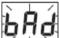
**Dead battery:** 이것은 배터리가 모두 소모되었고 교체되어야 함을 나타냄. 이 표시가 화면에 나타나면 정상적인 작동이 되지 않는다.. 배터리를 교체하고 기기를 다시 시작
