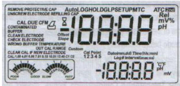
기기는 주요 LCD에는 날짜가 보이고 보조 LCD에는 깜박이는 “Remove protective cap(보호캡 제거)”와 “Unscrew electrode refilling cap(전극 보충캡 열기)”메시지와 함께 시간이 표시될 것이다.
